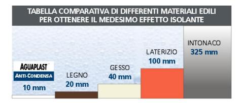
Esempio di constatata efficacia Anti-Condensa: Si è provato che su una superficie esposta a 21º C e 40 HR, un'applicazione di Aguaplast Anti-Condensa con spessore minimo di 5 mm aumenta di 8º C il punto di condensazione, rispetto alla stessa superficie non trattata con Aguaplast Anti-Condensa.
